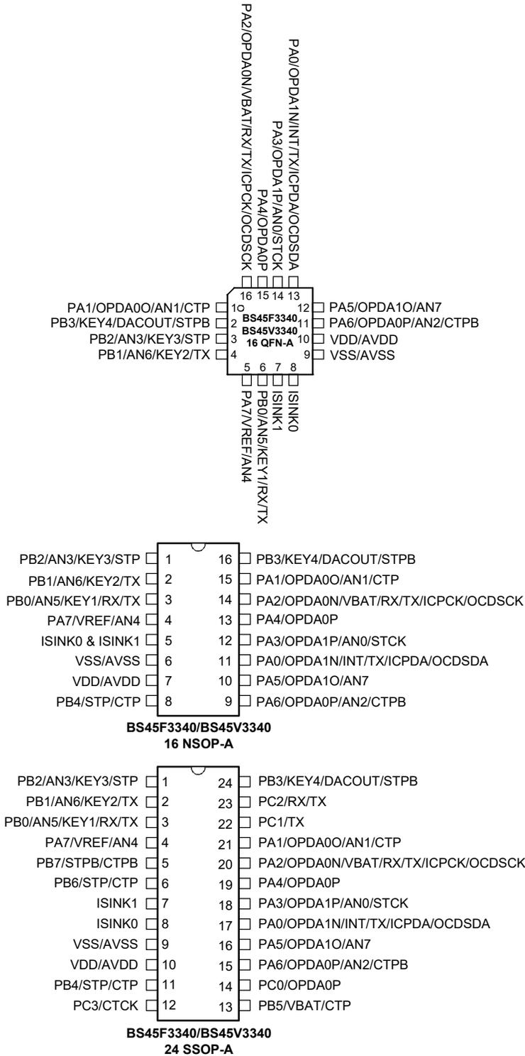
注：1. 若共用引脚同时有多种输出，所需引脚共用功能通过相应的软件控制位决定。
