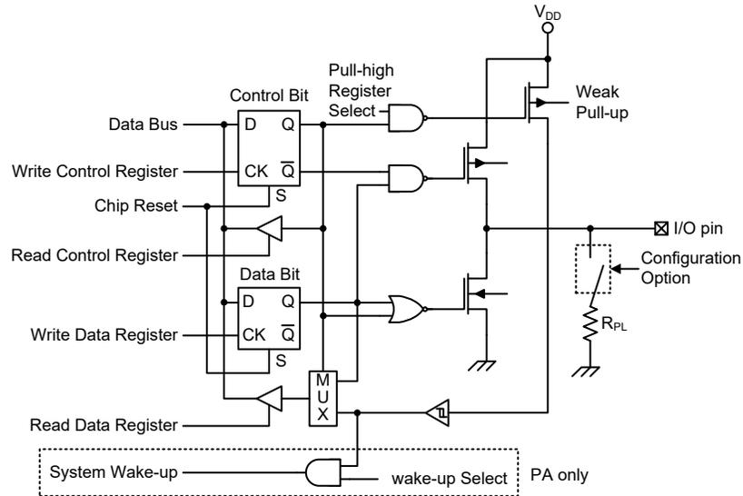
注：仅 PB4 引脚存在内部  $R_{PL}$  电阻，可由配置选项控制。
