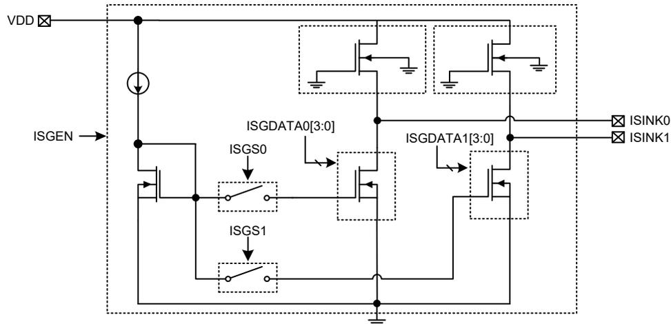
注：在 16-pin NSOP 封装中 ISINK0 和 ISINK1 打在同一引脚位置，或者在 16-pin QFN/24-pin SSOP 封装中，这两个引脚被用户自行外部接在一起使用时，若 ISGS0/ISGS1=0，则对应的 ISGDATA0/ISGDATA1 寄存器必须清零，以避免漏电流情况发生。
