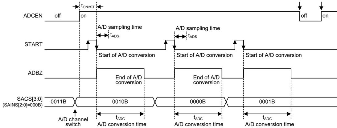
A/D 转换时序图 – 外部通道输入
