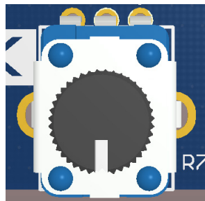
VR 可变电阻电路与实际元件布局
