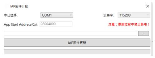
IAP 固件升级需要用户提前下载好需要更新的固件,使用串口工具将串口屏与电脑进行连接,选择对应的串口号以及需要更新的固件,点击 IAP 固件更新对串口屏进行固件更新。
