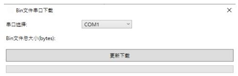
Bin 文件串口下载主要是将用户当前编辑的页面显示效果下载到串口屏中。在将显示文件下载到串口屏之前需要先将当前编辑的页面进行编译,只有编译成功后才能进行显示文件下载。在串口下载菜单中选择 Bin 文件串口下载功能,上位机会弹出上图所示的串口下载界面,使用串口工具将串口屏与电脑进行连接,并选择对应的串口,点击更新下载,上位机即可自动进行显示文件下载。同时串口下载窗口中会显示当前下载的显示文件(Bin 文件)的总大小以及下载的进度。
