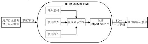
串口屏模块使用流程图
