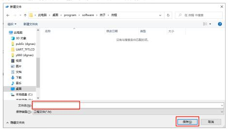
保存文档后会弹出设置界面,在设置界面选择对应的串口屏型号等信息,点击确认就完成新建工程。
