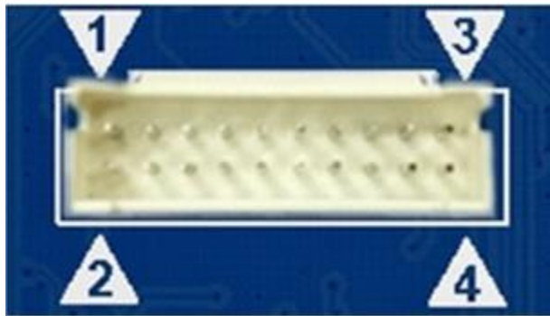
圖 19 20PIN (5PIN×4 ICP) PHB Connector
